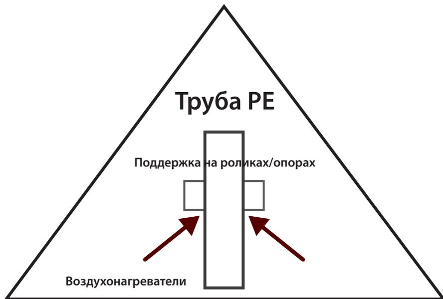
Рисунок 1 – Схема подогрева трубы
