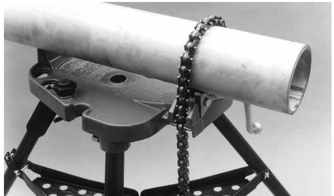
Figura 3. Montaje de tubo
